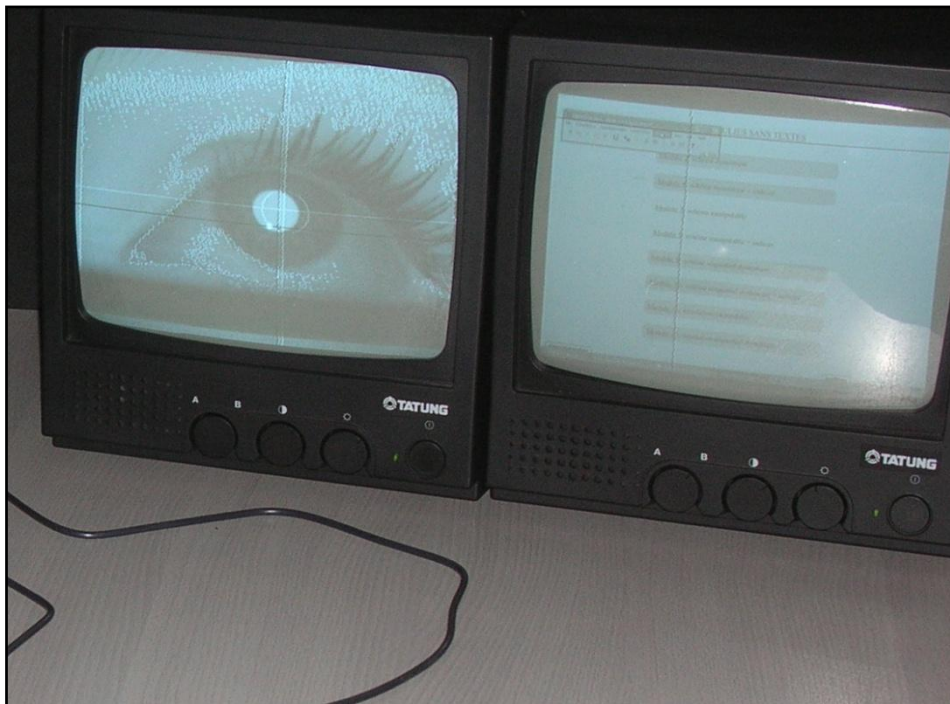
Figure 3.4. Système ASL 5000. Sur l'écran de gauche on peut apercevoir le centre de la pupille illuminée indiqué par l'axe blanc et le reflet cornéen indiqué par l'axe noir. L'axe de l'écran de droite représente la position de l'œil sur l'écran que le sujet a devant lui.
